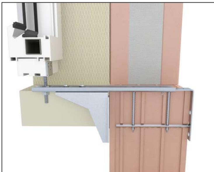
Кронштейн WU-ST-анкер с дополнительным крепежным углом
