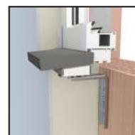
5.4. T-AFBH - держатель для алюминиевых дверных подоконников (порогов) с терморазрывом.....84
