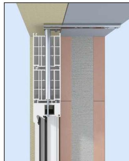
Стабилизатор расширительного профиля 300-350x3,0
