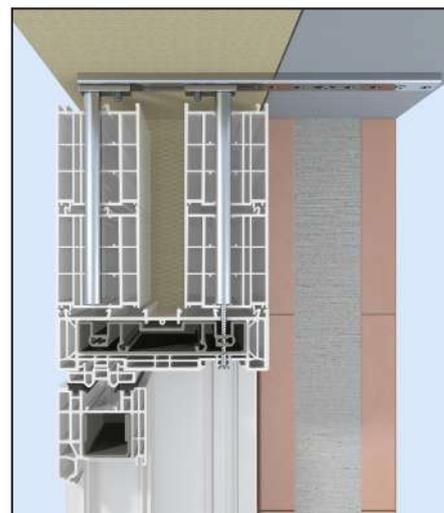
Стабилизатор расширительного профиля HST 300-350x3,0
